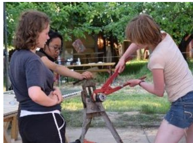
Gewindeschneiden auf das Ende eines Wasserrohres
