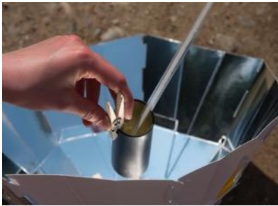
Experiment: Bau eines Parabolspiegels und Messen der Temperatur
