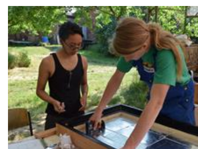
Antackern der reflektierenden Spiegelfolie
